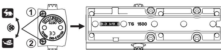
! Einstellung Türschließergröße über drehen des Gestängeoberteils / closing size setting by turning the upper part of the rod assembly
