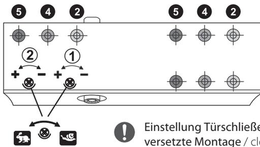
! Einstellung Türschließergröße über versetzte Montage / closer size setting via staggered mounting
